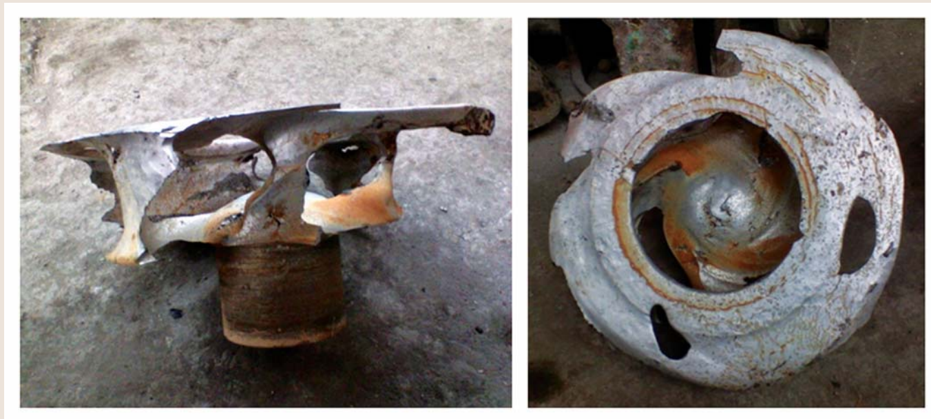
Рис. 1. Виды изношенного рабочего колеса грунтового насоса 8Гр-8.
