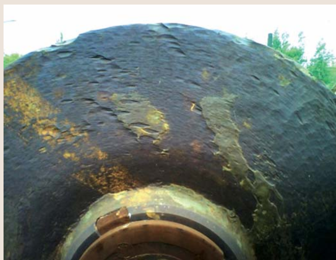
Рис. 2. Характер разрушения рабочего колеса насоса 2Гр 8000/71.
